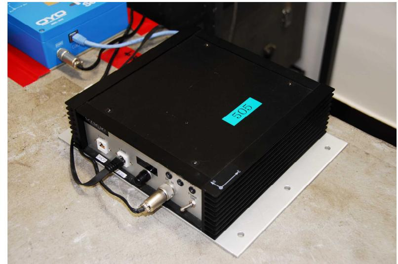
これまでに、通常の小型PCを内蔵した試作機(鷹野他 2004), 静電容量型センサを内蔵したデジタルセンサをサーバに多数接続した建物IT強震計を開発(鷹野他 2005), 観測に活用している. 建物IT強震計については導入箇所も増え, 独自アプリケーションの開発も順調に進んでいる.
